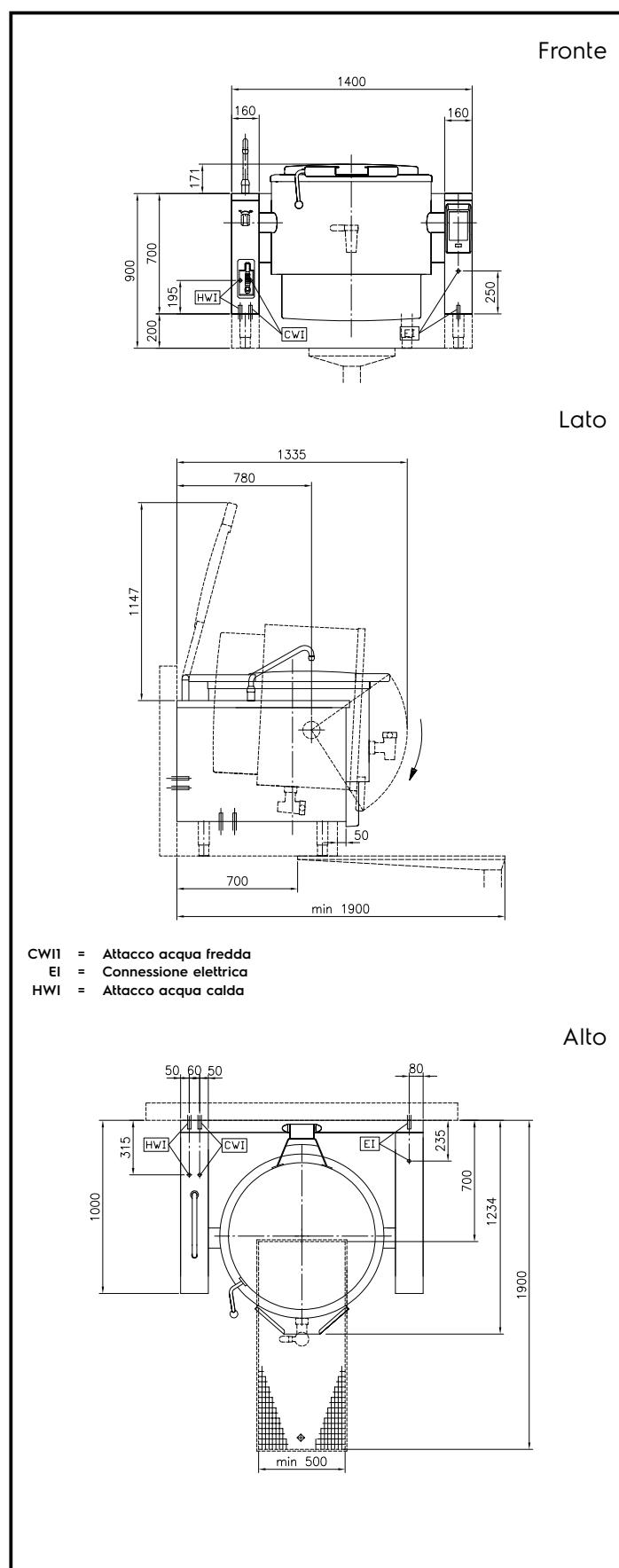
Pentola elettrica basculante 200 lt. (h), carico automatico acqua calda/fredda con rubinetto, doccetta, kit di chiusura posteriore.
